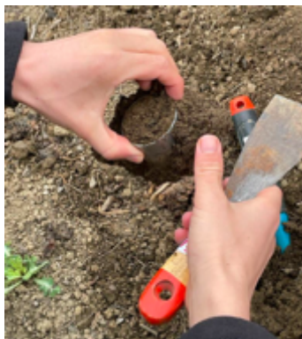
Abbildung 11: Probennahme zur Ermittlung der Lagerungsdichte mit dem Stechzylinder
