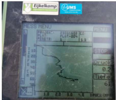
Abbildung 2: Penetrologger-Einstich, Parzelle 4 (Betrieb Krautwerk): Eindringwiderstand (in MPa), Cone Index (CI); Mittelwert der gemessenen Eindringwiderstände in Megapascal (MPa), 16.3.2023
