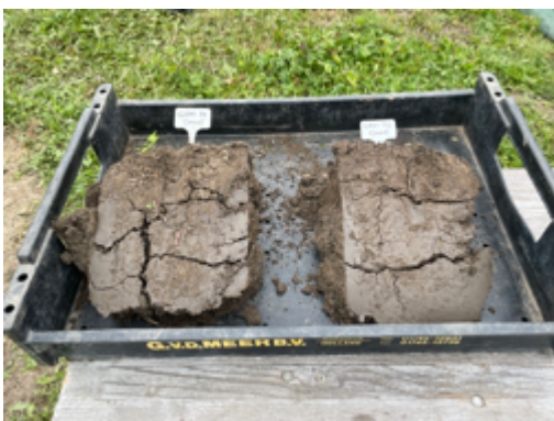
Abbildung 8: Bodenwürfel - Beurteilung der Bodenstruktur
