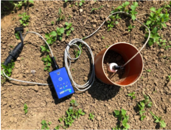
Abbildung 4: Messgerät Hydra Go bei Messung von 0-10 cm Tiefe
